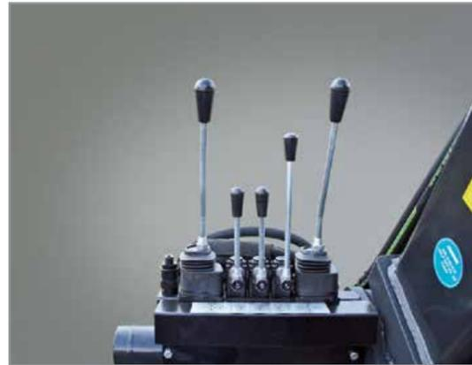
Kreuzhebelsteuerung – 7fach mechanisch
