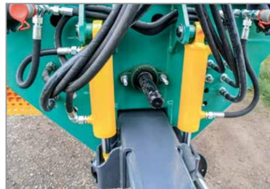
Hydraulisch gefederte Zugdeichsel
