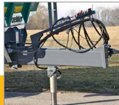
**NEU** Optional: seitlich kippbar mit hydraulischer Ver-/Entriegelung
