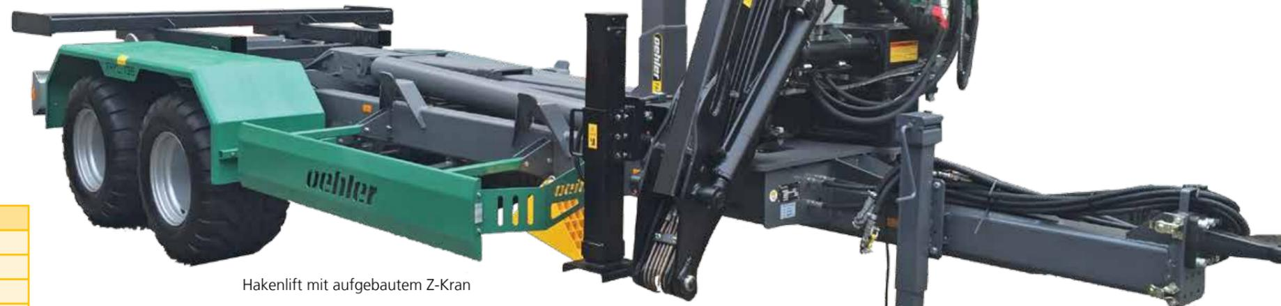
Hakenlift mit aufgebautem Z-Kran
