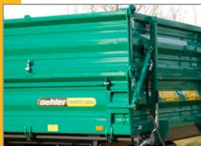
Hydraulisch verschließbare Bordwand
