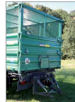
OL EDK 70 mit Laubaufsatz-kasten für Sauger und Dreipunktaufnahme Optional
