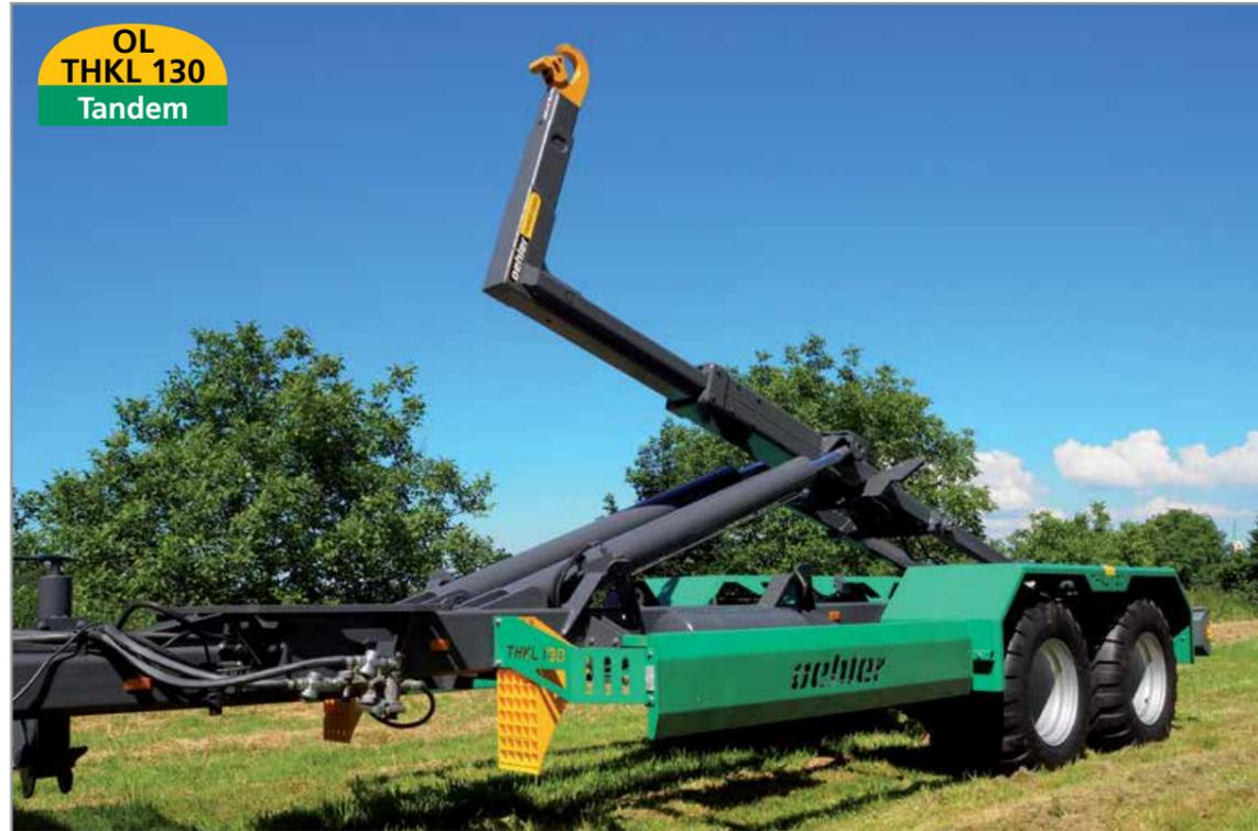
OL THKL 130 Kotflügel und Seitenanfahrerschutz
