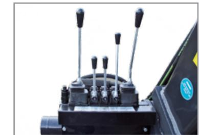
Kreuzhebelsteuerung 7-fach mechanisch
