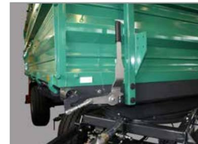
Kipplager mit Überkreuzstecksicherung
