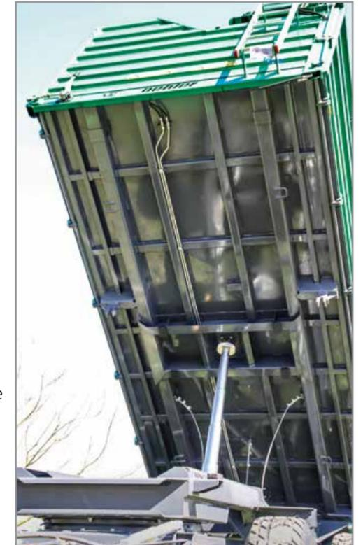
Öl- und Druckluftleitung nach hinten verlegt
