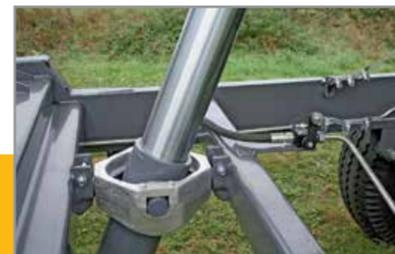
Umschaltventil für 2. Ölanschluss hinten
