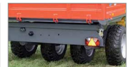
Pendelachse 4-fache Bereifung
