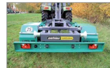
OL EHKL 80 Unterfahrerschutz mit Beleuchtungsanlage
