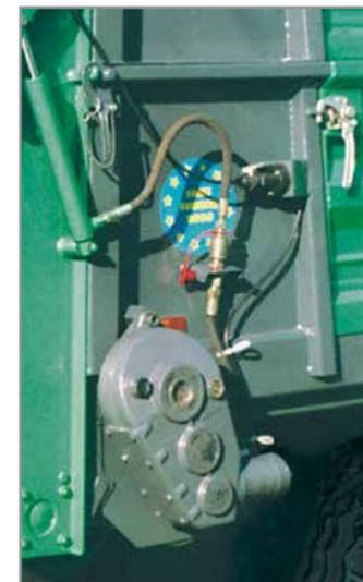
Getriebe + Danfoss-Ölmotor
