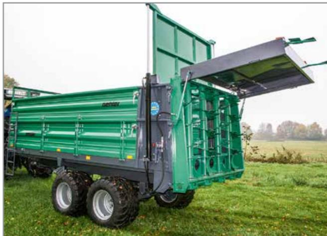
OL STT 80 mit Stauschieber + hydraulischem Streuschutz
