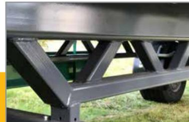
Ballenwagen mit Doppelrohrrahmen
