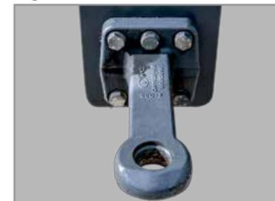
Gefederte Zugdeichsel bis max. 4t Stützlast
