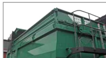
Hydraulisch abklappbarer Aufsatz
