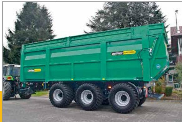
Gefederte Zugdeichsel bis max. 4 t Stützlast
