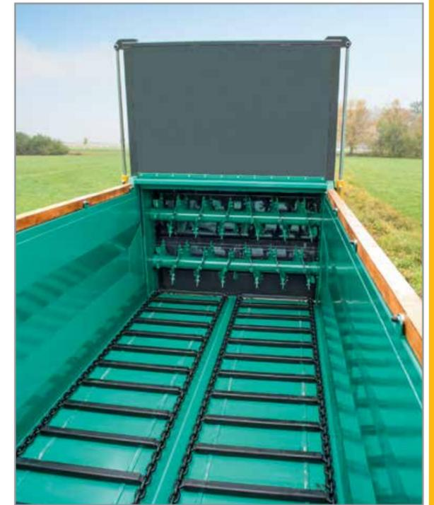
Kratzbodenleisten Hydraulischer Stauschieber
