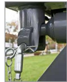
Kipplager mit Überkreuzstecksicherung
