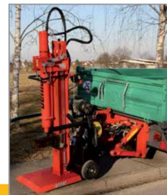
OL EDK 60 S mit Dreipunktbau und Zapfwelldurchtrieb mit Holzspalter OL 190
