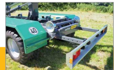
OL THKL 130 ausziehbarer Unterfahrerschutz
