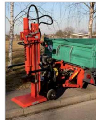
OL EDK 60 S mit Dreipunktanbau und Zapfwellendurchtrieb mit Holzspalter OL 190
