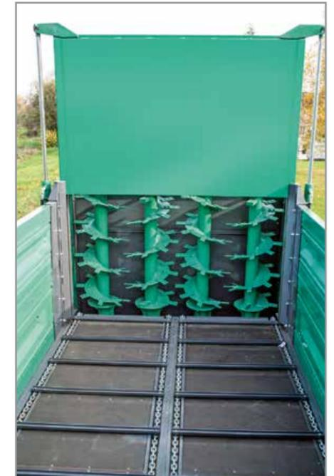
Kratzbodenleisten Hydraulischer Stauschieber
